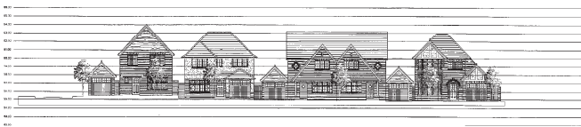
Street Scene A-A Elev 1 FFL 2.00m Elev 2 FFL 2.40m Elev 3 FFL 2.80m Elev 4 FFL 3.20m Elev 5 FFL 3.60m
